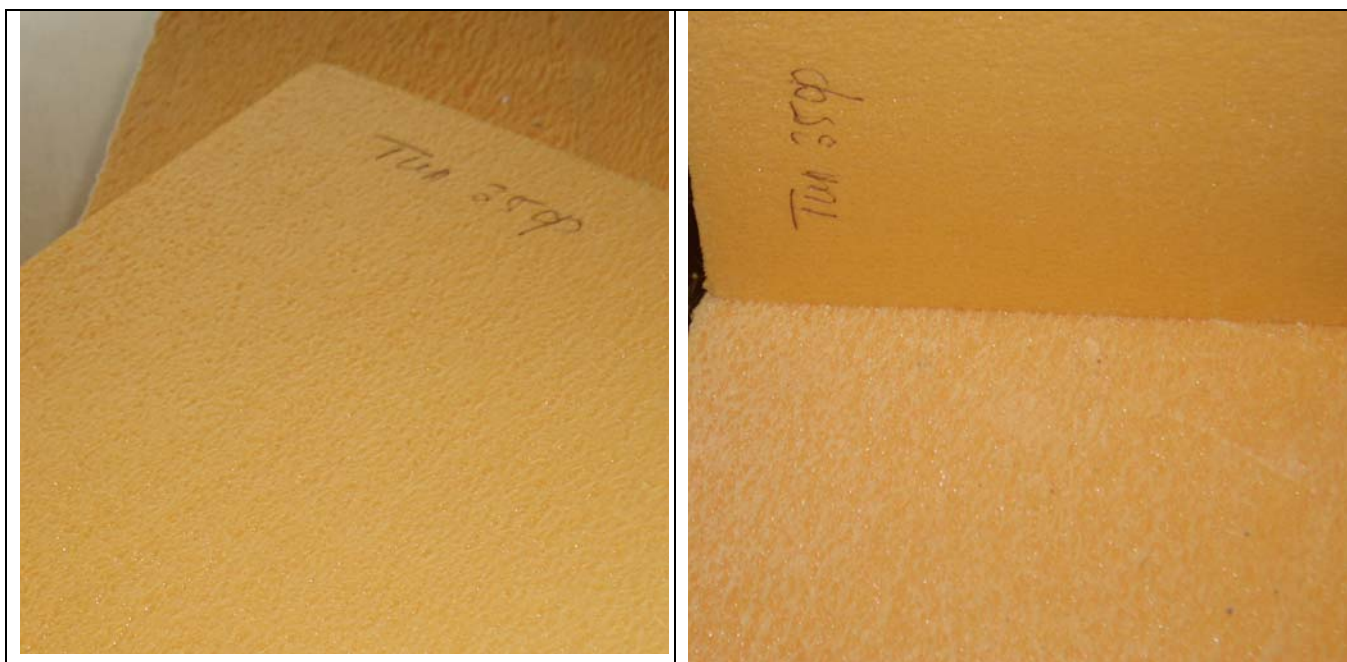
Рис. 1. Наружная поверхность фрезерованных плит ПЕНОПЛЭКС марки 35Ф обладает «шероховатостью», что повышает прочность их сцепления с армировочно-клеевыми составами в системах наружного утепления с тонким штукатурным слоем
